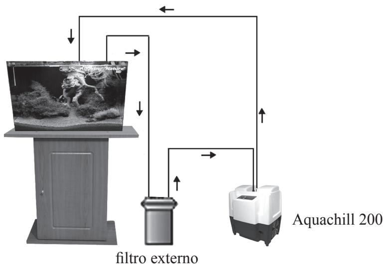
Para evitar uma diminuição na eficiência, minimizar o comprimento do tubo de água entre o AquaChill 200 e o aquário (aplicar uma posição correcta). Por outras palavras, a distância entre a saída do filtro e a entrada no AquaChill 200 deve ser a mais curta possível
